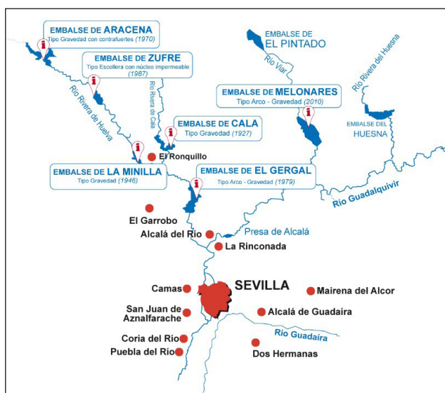
Figura 2. Embalses de regulación del sistema de abastecimiento y poblaciones servidas en baja por la Empresa Metropolitana de Abastecimiento y Saneamiento de Sevilla.
